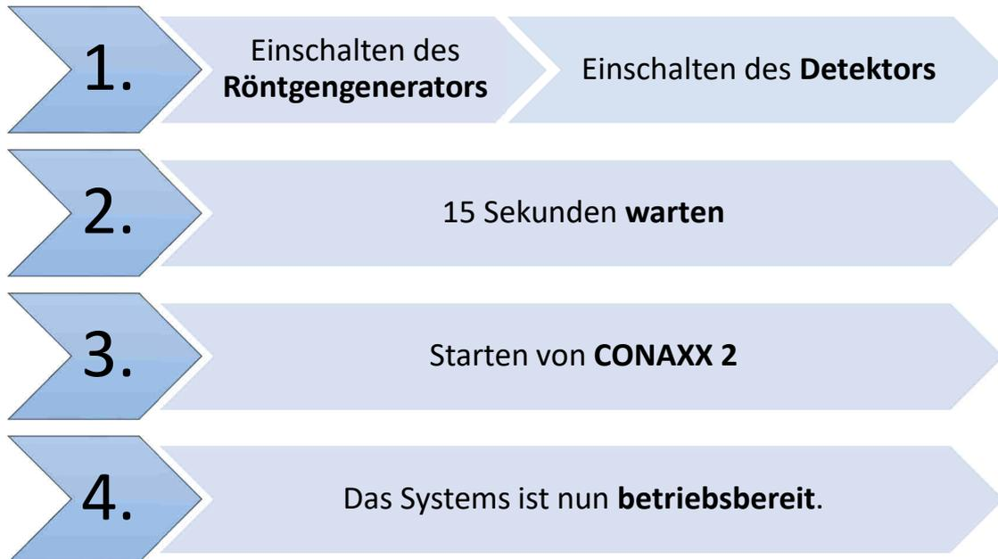
Kann sich das CONAXX 2 bei Programmstart nicht mit der Modalität oder dem Generator verbinden, erscheint eine Fehlermeldung. In diesem Fehlerfall muss CONAXX 2 neu gestartet werden, um einen erneuten Verbindungsversuch zu initiieren.
