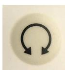
Durch Betätigen dieser Taste wird die Bremse für die Rotationsbewegung des Querarms gelöst. Bei gedrückter Taste kann der Querarm in eine gewünschte Schräglage gedreht werden. Auf der Rotationsskala wird die Drehung in Grad relativ zur waagrechten Ausgangsposition gezeigt.
