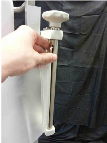
Schritt 4: Den Gurt halten und gleichzeitig zum Spannen am Handrad drehen.
