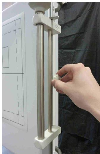
Schritt 2: Feste Spannwalze in die linke Schiene einschieben und auf gleicher Höhe, wie die Spannwalze auf der rechten Schiene, fixieren.
