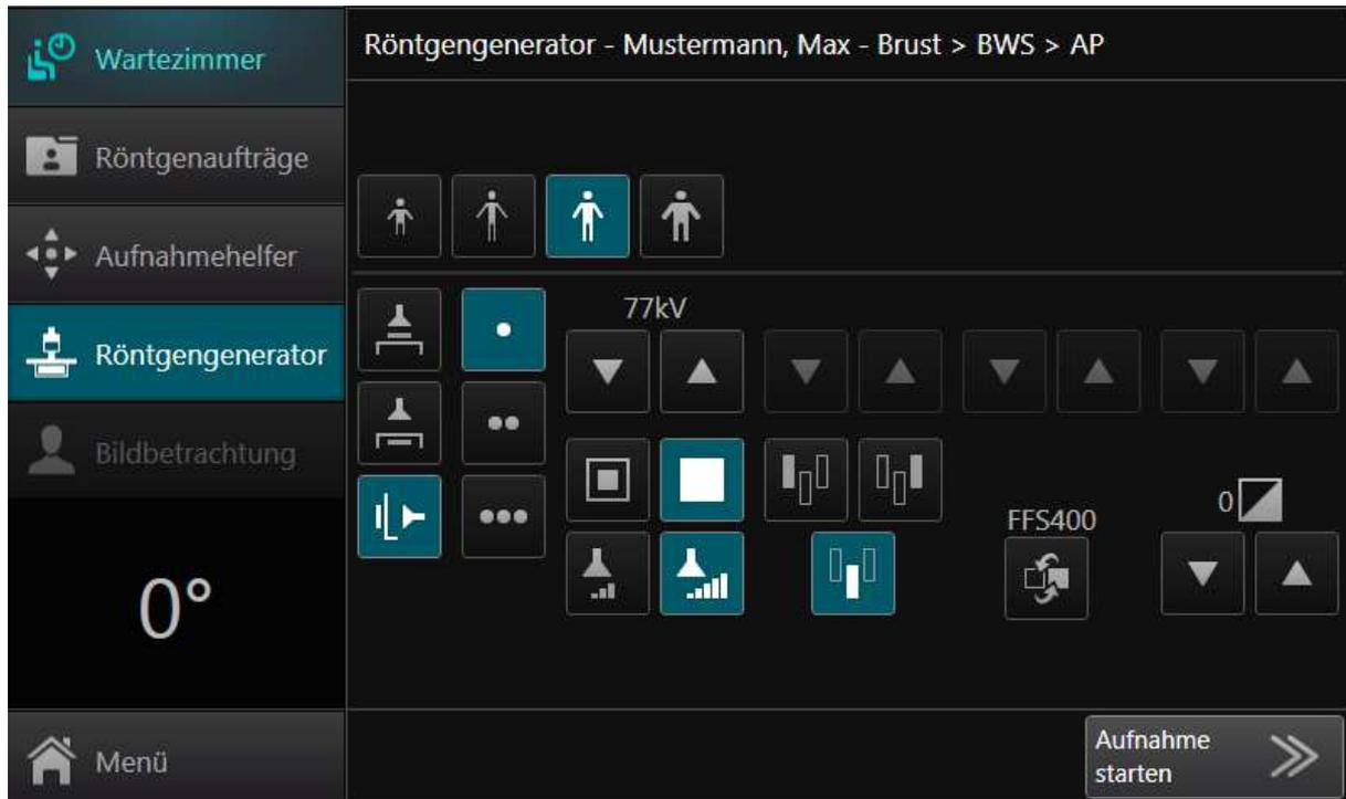
In diesem Bereich kann der Nutzer die Röntgenparameter für die Aufnahme steuern. Beim Betreten des Bereiches werden die Röntgenparameter in Form von Organprogrammen automatisch beim Generator gesetzt. Über die folgenden Organparameterschaltflächen können weitere hinterlegte Röntgenparameter gesetzt werden.
