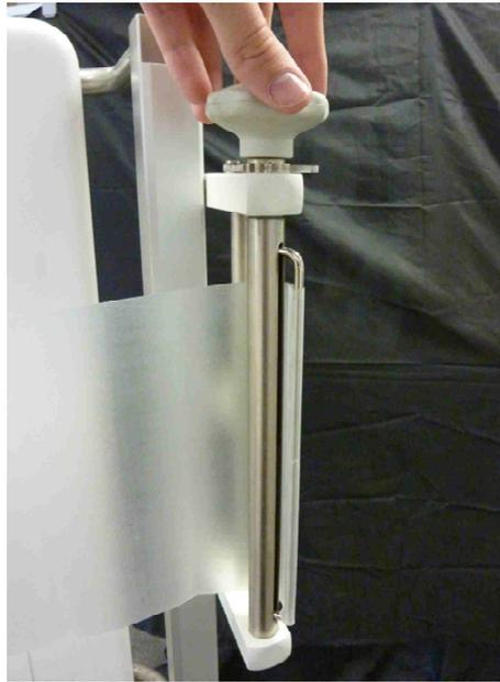
Paso 5: Para soltarla, gire la rueda tensora un poco más y pliegue la palanca de bloqueo hacia delante. Desenrosque la rueda tensora y retire la correa en orden inverso.
