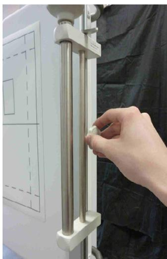
Paso 2: Introduzca el rodillo tensor fijo en el carril izquierdo y fíjelo a la misma altura que el rodillo tensor del carril derecho.
