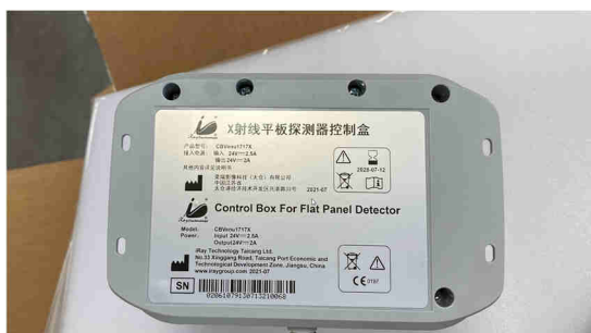
Die Typenschilder befinden sich auf der Unterseite der Control Box.
